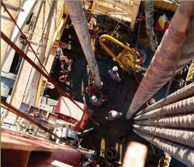
*Operación de Orly Choisy: la tuberías de la perforación se van ensamblando las unas a las otras a medida que progresa la perforación.*
